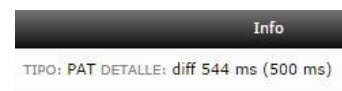
3-Detalle de alarma. Informa que el delay de la PAT fué de 544ms cuando lo permitido es 500ms
